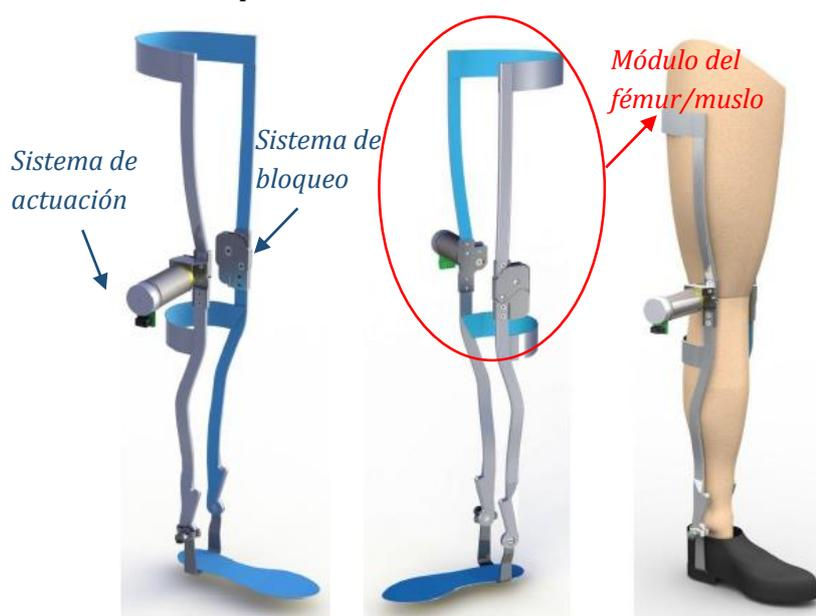
FIGURA 4-15 DISEÑO DE ORTESIS ACTIVA SOLA Y MONTADA SOBRE UN MODELO DE PIERNA
