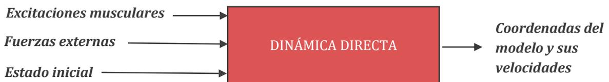
FIGURA 3-5 DIAGRAMA DE BLOQUES DE LA DINÁMICA DIRECTA
