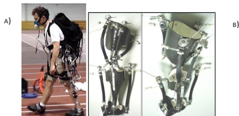
FIGURA 2-2 A) EXOSKELETO CUASI-PASIVO DEL MIT [18] Y B) MÚSCULOS ARTIFICIALES NEUMÁTICOS [20]
