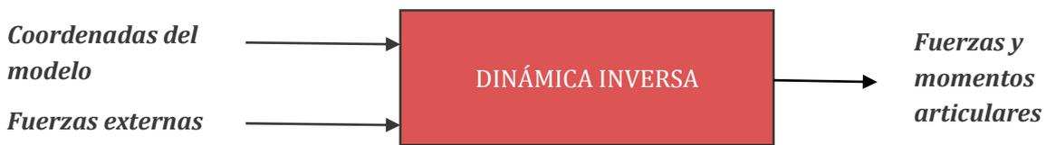
FIGURA 3-4 DIAGRAMA DE BLOQUES DE LA DINÁMICA INVERSA
